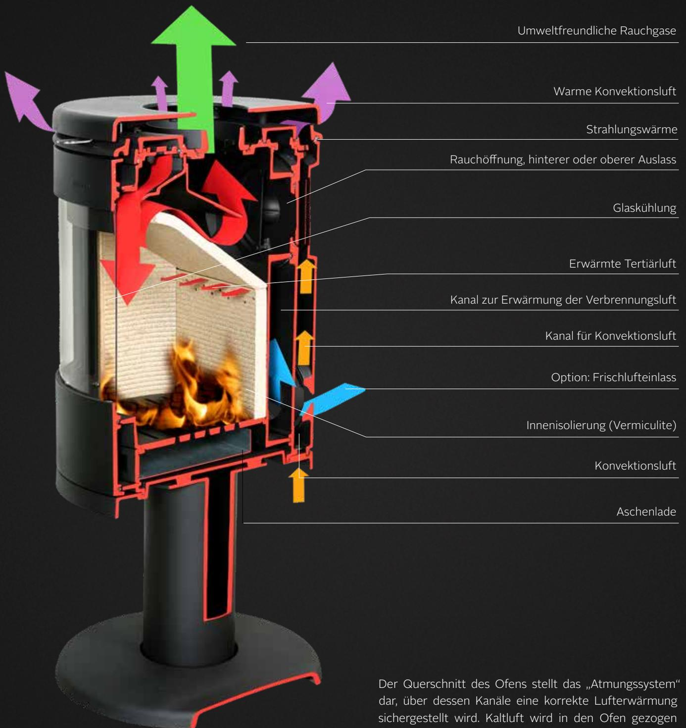
Der Querschnitt des Ofens stellt das „Atmungssystem“ dar, über dessen Kanäle eine korrekte Lufterwärmung sichergestellt wird. Kaltluft wird in den Ofen gezogen und zur Erwärmung durch die Kanäle geleitet. Durch die erwärmte Luft wird eine optimale Spülung der Scheiben erreicht und somit sichergestellt, dass das Glas stets sauber und rußfrei bleibt. Diese erwärmte Luft wird den Flammenspitzen als Tertiärluft zugeführt und ermöglicht somit ein Zünden der Holzgase.
